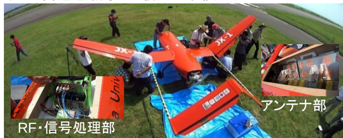
図2. 災害監視、人命救助等用の当研究室のCP-SAR搭載大型無人航空機(JXシリーズ)
