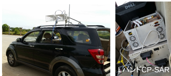
図1. 高速道路周辺監視用の車載用CP-SARシステム
